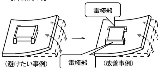
ストレスの作用する方向に対して、横向き(長さ:a<b)に部品を配置して下さい。
