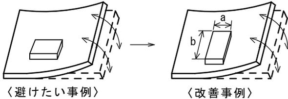
ストレスの作用する方向に対して、横向き(長さ:a<b)に部品を配置して下さい。
