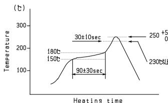
\* リフロー回数 : 2回まで 250 <sup>+5</sup> to Reflow times : 2 times max
