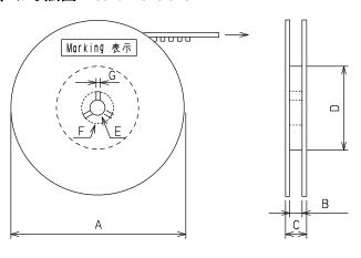
$\phi$  330  $\pm \overline{2}$ Α  $13.5 \pm 0.5$ В C  $17.5 \pm 1$  $\phi 80 \pm 1$ D  $\phi$  13  $\pm$  0.2 Ε F  $\phi 21 \pm 0.8$
