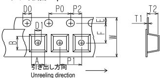
単位 Unit:mm  $6.4 \pm 0.1$ 4.0 ±0.1 P0  $6.4 \pm 0.1$  $8.0 \pm 0.1$ В P1  $\phi$  1.5 +0.1 $2.0 \pm 0.1$ D0 P2  $0.4 \pm 0.1$ D1 T1  $1.75 \pm 0.1$  $3.0 \pm 0.1$ Ε T2  $12.0 \pm 0.3$  $5.5 \pm 0.1$ W
