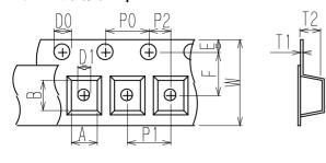
単位 Unit: mm  $1.85 \pm 0.1$ P<sub>0</sub>  $4.0 \pm 0.1$ В  $2.25 \pm 0.1$ P1  $4.0 \pm 0.1$  $\phi 1.5 + \frac{1}{0.1}$  $2.0 \pm 0.05$ D<sub>0</sub> P2 +0.1 -0 D1  $\phi$  1.0 T1  $0.25 \pm 0.05$ Ε T2  $1.75 \pm 0.1$  $1.1 \pm 0.1$ F W  $3.5 \pm 0.05$  $8.0 \pm 0.2$
