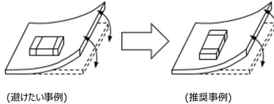
ストレスの作用する方向に対して横向きに部品を配置してください。
