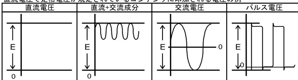
(E : 最大可能印加電圧=DC 定格電圧)
