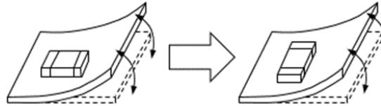
ストレスの作用する方向に対して横向きに部品を配置してください。
