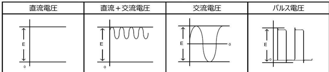
(E：最大可能印加電圧 = DC 定格電圧)
