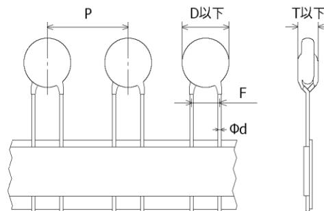
注) 端子形状の'\*'はリード線間隔 (F)・線径 (d)・製品ピッチ (P) により異なります。
