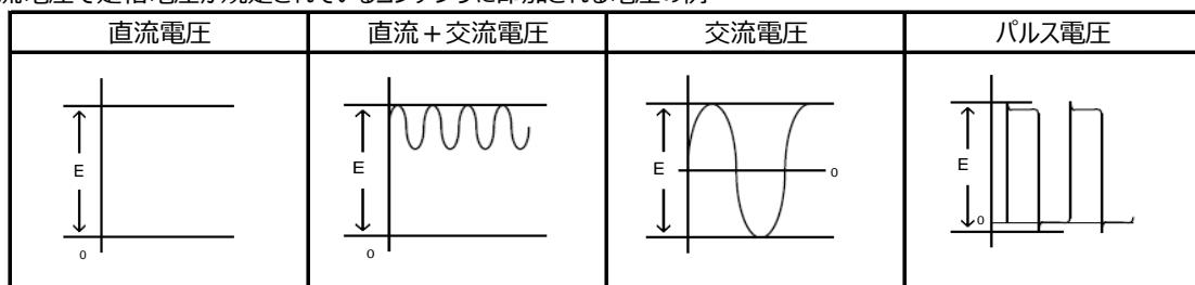
(E : 最大可能印加電圧 = DC 定格電圧)
